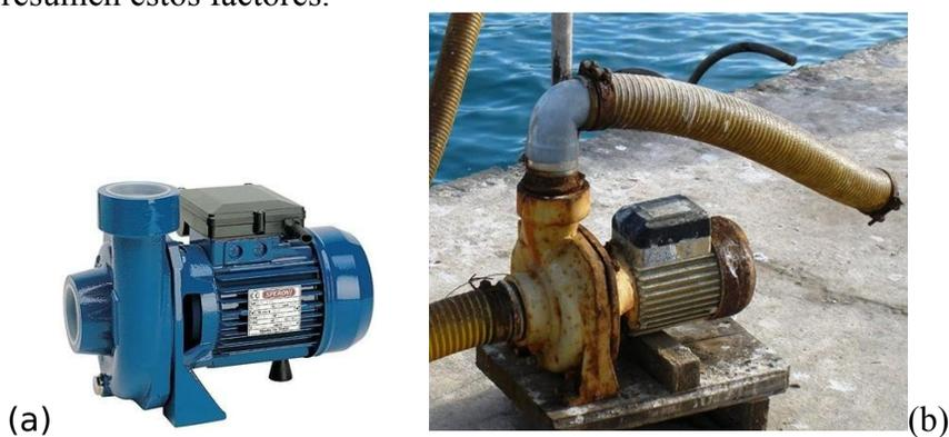
**Figura 1.** (a) Bomba de agua nueva, lista para su aplicación y (b) Bomba de agua después de un tiempo de uso en ambiente marino.
