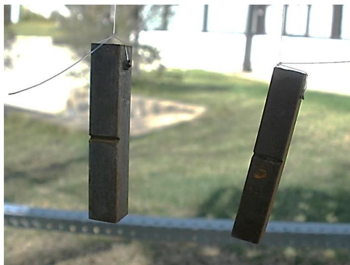
**Figura 4.** Corrosión heterogénea en muestras de acero, muestras en un mismo bastidor presentan zonas corroídas en distintos puntos una en la entalla y la otra en toda la superficie.
