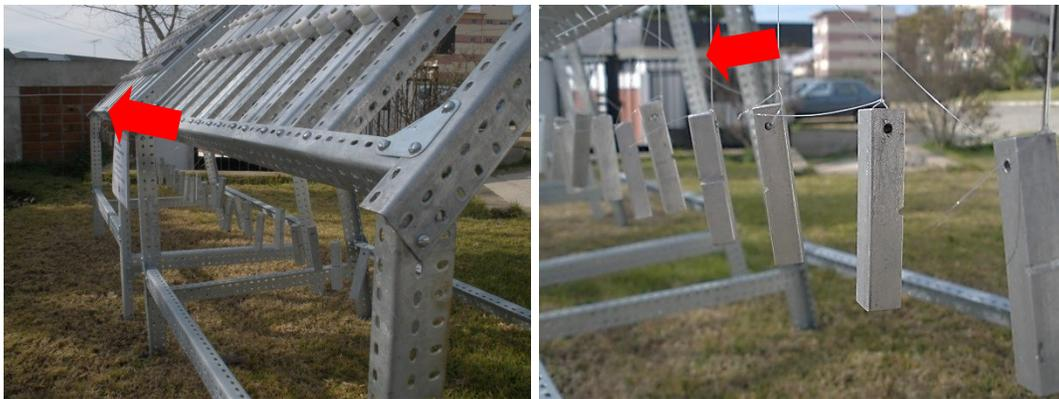
**Figura 3.** (a) Probetas Charpy en los bastidores de cada estación y (b) ampliación de (a) mostrando cómo se montaron las probetas colgando del bastidor.
